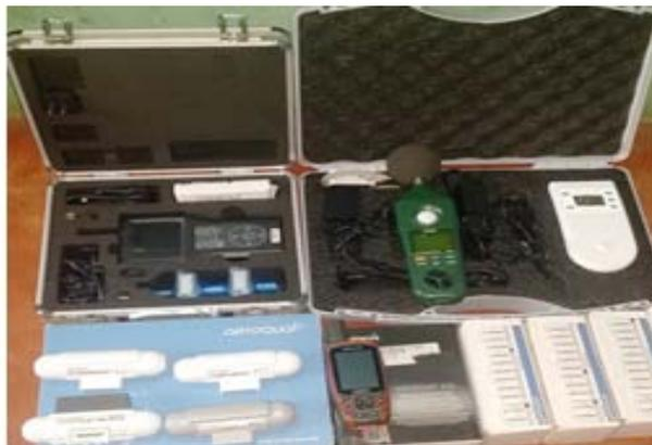
**Vue des équipements de mesures des paramètres écologiques (hygromètre, luxomètre, thermomètre, vitesse du vent) ; de la qualité de l'air (compteur de particule laser portatif PM<sub>0,5</sub>; PM<sub>2,5</sub>; PM<sub>5</sub>; détecteur multigaz avec capteurs de CO<sub>2</sub>, CH<sub>4</sub>, CO, NO<sub>2</sub>, SO<sub>2</sub>, et O<sub>3</sub>) et de positionnement (GPS)**
